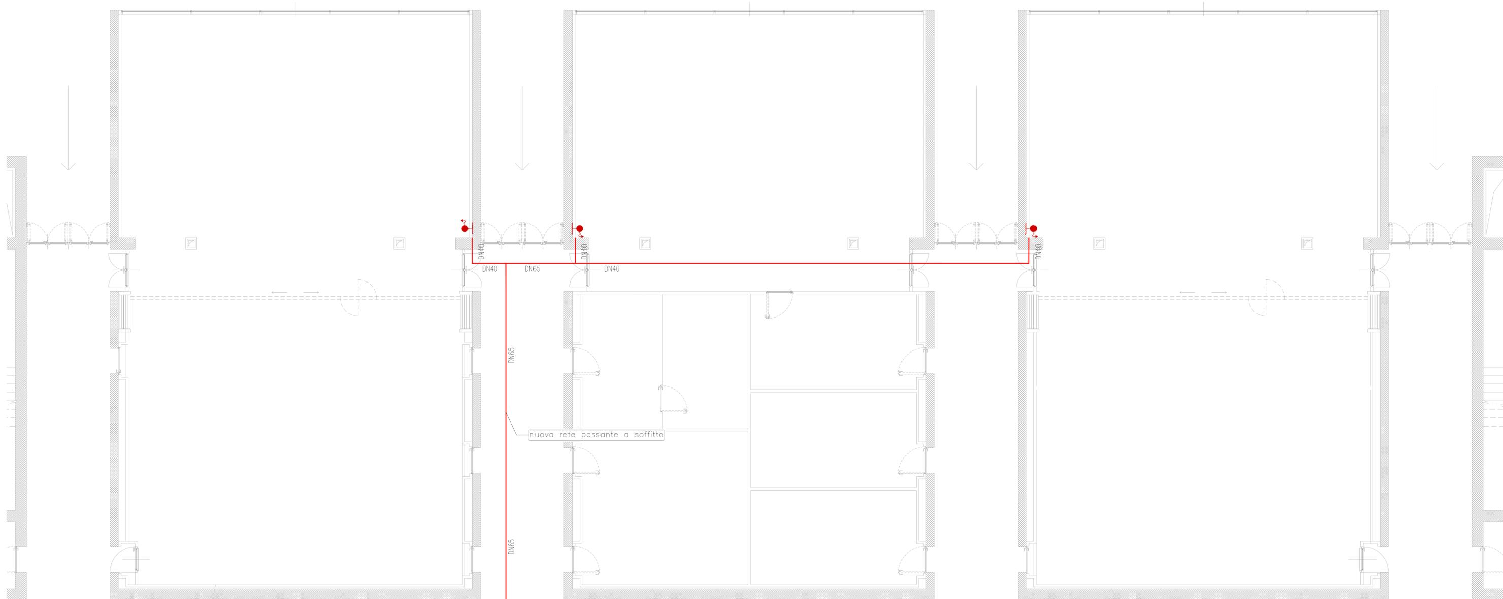
Allacciamento all'anello esistente passante a quota -2.90. Il percorso delle tubazioni dovrà essere verificato in cantiere dopo la rimozione dei controsoffitti
